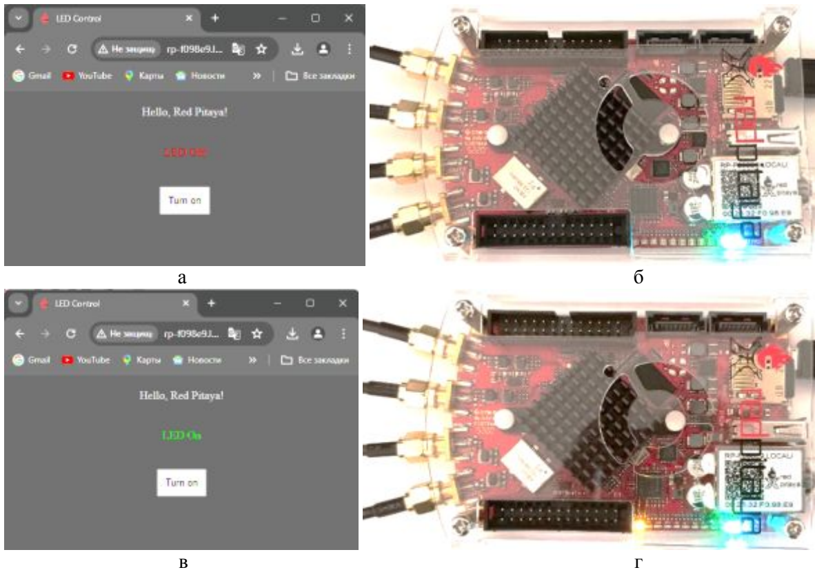
Рис. 10. Результат роботи додатку LED control : а) вимкнення світлодіоду RP_LED0; б) вимкнений світлодіод RP_LED0; в) ввімкнення світлодіоду RP_LED0; г) ввімкнення світлодіоду RP_LED0
