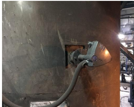
Рис. 2. Прилад датчику Durag, що застосовується у аглодоменному переділі
