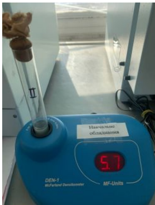
Рис. 2. Визначення титру МКБ в дослідних зразках (1—10) на денситометрі DEN-1
