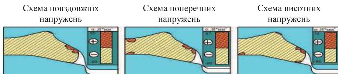
Рисунок 6 – Схема напруженого стану у перерізі, що знаходиться на відстані 20 мм до вертикальної осі валків
