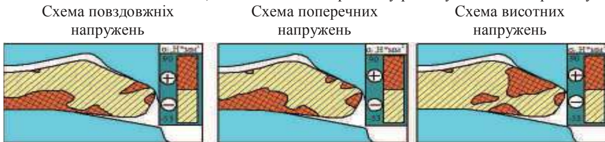
Рисунок 4 – Схема напружень на вході в осередок деформації
