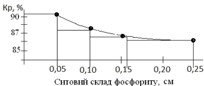
Рисунок 1 – Залежність ступеня вилучення (Кр) P_2O_5 фосфориту від тонины помелу
