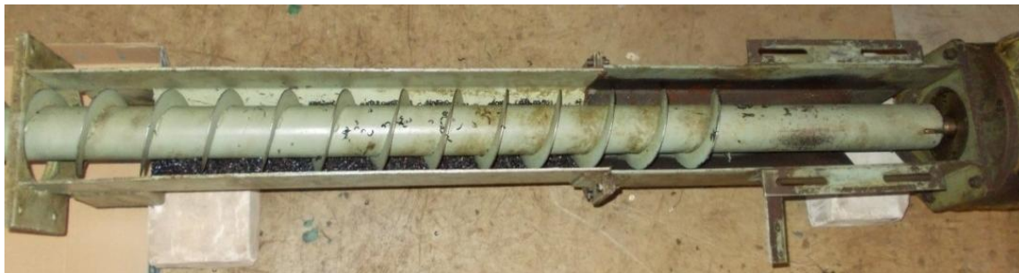
Рисунок 1 – Експериментальний шнековий конвеєр (вид зверху)
