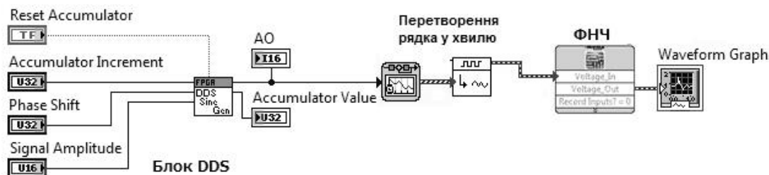
Рисунок 6 – Цифровий синтезатор з ФНЧ
